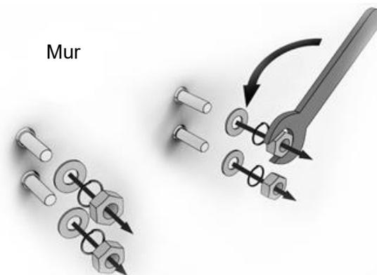
**Étape 3 :** Fixer fermement le chauffage au mur à partir du support en mettant les rondelles et en vissant les 4 boulons.
