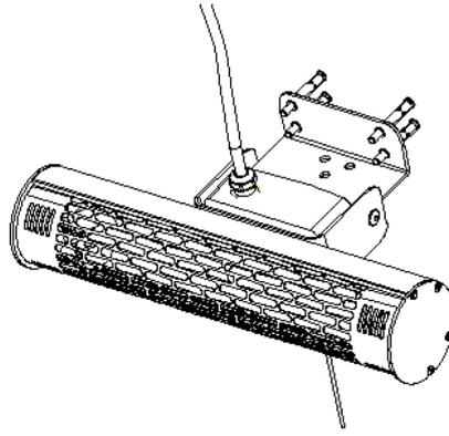
**Cet appareil doit être impérativement fixé au mur avec les supports fournis pour permettre une bonne ventilation.**
